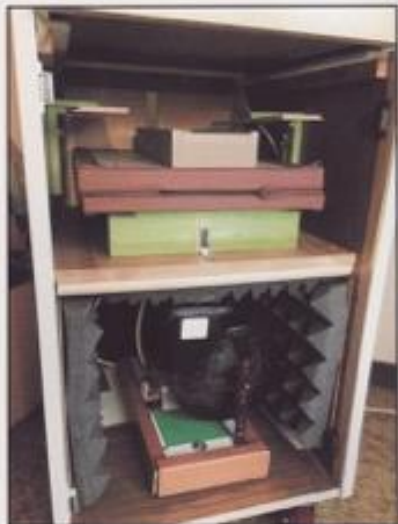
Figura 4. Sistema di generazione d'aria.
