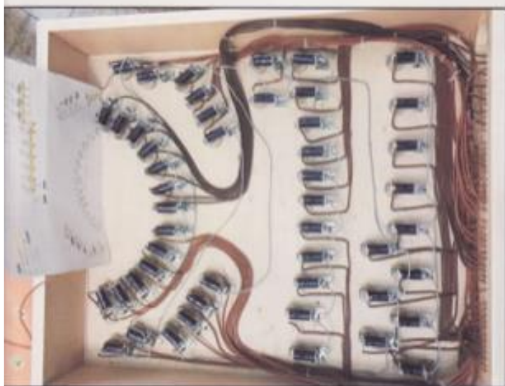
Figura 6. Cablaggio magneti nel somiere.
